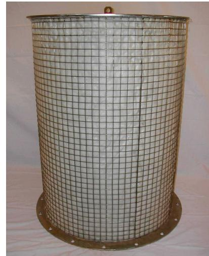
Решением при низкой скорости приближения частиц стал так называемый «патронный» фильтр, в котором волокно помещается в 5-санитметровое пространство между двумя концентрическими цилиндрами, изготовленными из устойчивой к коррозии сетки.
