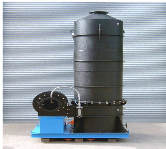
Скруббер «BECOFLEX» - оптимальное решение для применения в сфере очистки вентиляционных газов, когда движение воздуха, производимое нагнетанием щетки, действующей в качестве рабочего колеса, означает, что отдельный вентилятор не требуется. В результате получается комбинированный прибор из вентилятора и скруббера.
