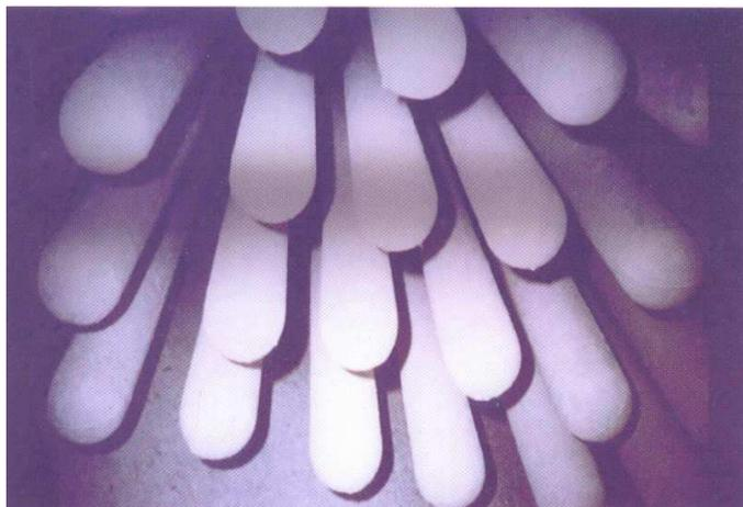
Фильтровальные элементы изготавливаются из алюмосиликатных керамических волокон. Диаметр таких волокон – приблизительно 2,5  $\mu$ , это очень немного по сравнению с показателями для большинства очищаемых фильтровальных элементов. Тонкое фильтровальное волокно, совмещенное с фильтровальным элементом толщиной 8 мм, отличается высокой, обычно 100% , эффективностью удаления твердых частиц
