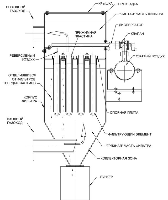
При прохождении газа через пористые стенки фильтровальных элементов, твердые частицы, захваченные потоком газа, собираются на поверхности элементов. Через некоторое время слой твердых частиц становится достаточно толстым. Для продолжения фильтрации его необходимо удалять. Очистка керамических элементов производится спадающим импульсом сжатого воздуха и происходит во время работы фильтра.
