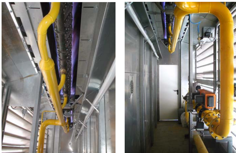
Прямой воздушный обогрев, осуществляемый с помощью горелок NP-III AIRFLO® в сушилках с непрерывным током воздуха, предназначенных для зерна.
