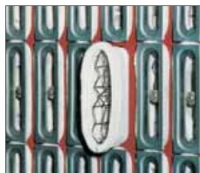
Вид перфорированной плиты для горизонтально расположенных фильтрационных рукавов
