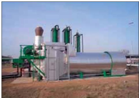
**Катализитические системы дожигания** газов служат для очистки отработанного воздуха от технологического оборудования при низких температурах камеры сгорания. Катализаторы подбираются индивидуально для каждого конкретного задания. Благодаря использованию высокоэффективных пластинчатых теплообменников, возможна эксплуатация данного оборудования при низкой концентрации растворителей, также без сжигания дополнительного топлива.
