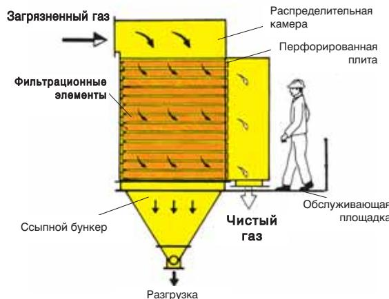
Схема рукавного фильтра типа **FLAT-BAG**
