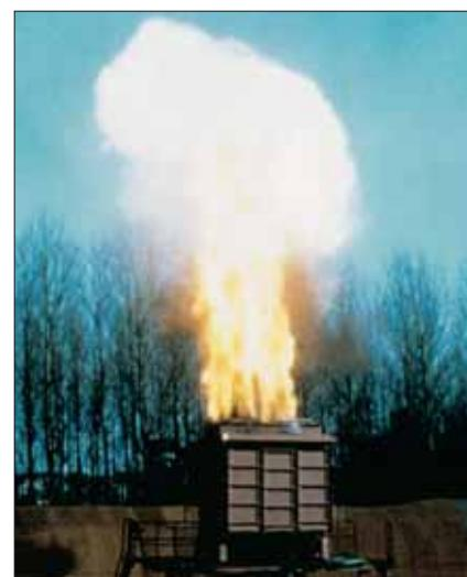
Взрывное испытание фильтров *FLAT-BAG*
