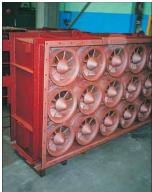
Мультициклон является устройством, основанным на опыте, полученном при эксплуатации циклонов. Отличается он высокой пропускной способностью при относительно небольших габаритах.
