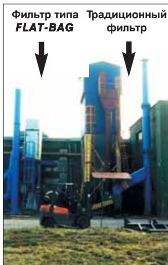
Различие в габаритах оборудования при тех же фильтрационных площадях
