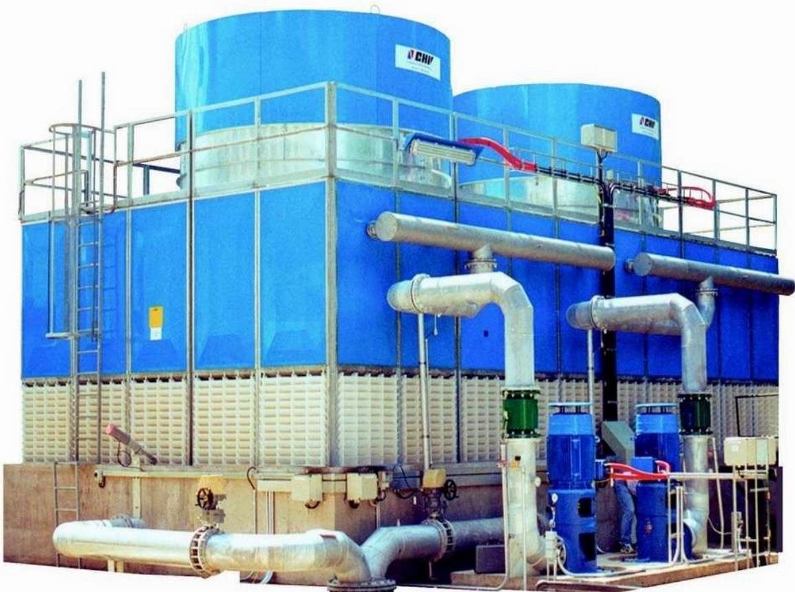
**Микрографирни** являются малыми жидкостными атмосферными охладителями воды для производственных целей, в которых подаваемая вода разбрызгивается специальными распылителями (форсунками) на полимерную загрузку, стекает по ее поверхности и передает тепло циркулирующему воздуху, который всасывается вентилятором, размещенным в верхней части микрографирни. В зависимости от конструкции и холодопроизводительности микрографирни делятся на несколько типов (см. таблицу).
